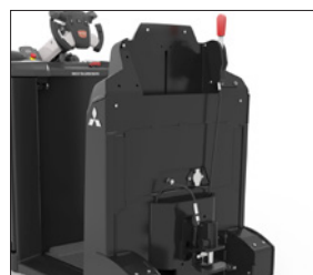
Acoplamiento automático con mango ergonómico de desbloqueo.
