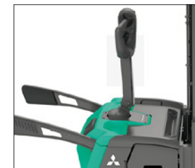
Brazo del timón del sistema de dirección mecánica
