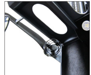
Ventilador en la cabina
