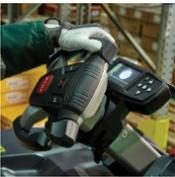
**La dirección eléctrica avanzada** ofrece un control preciso en velocidad, con reducción automática de la velocidad en curvas y centrado automático de la rueda motriz.
