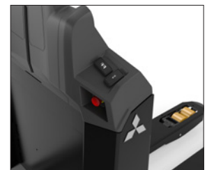
Botón de conductor acompañante y botones para elevación/descenso en los laterales del respaldo.
