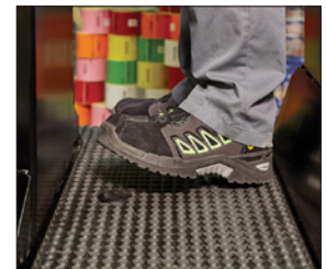
Interruptor de pie para descender la plataforma del operario.
