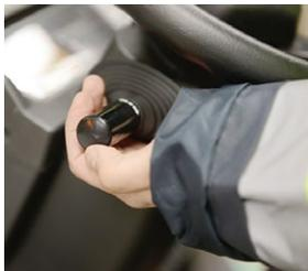
Palanca de control de dirección en el volante (opcional)
